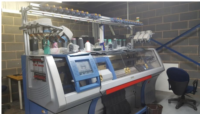
Ffigwr 11 Peiriant gwau aml-fedrydd Stoll sy'n cael ei ddefnyddio gan Camira Technical Knit
