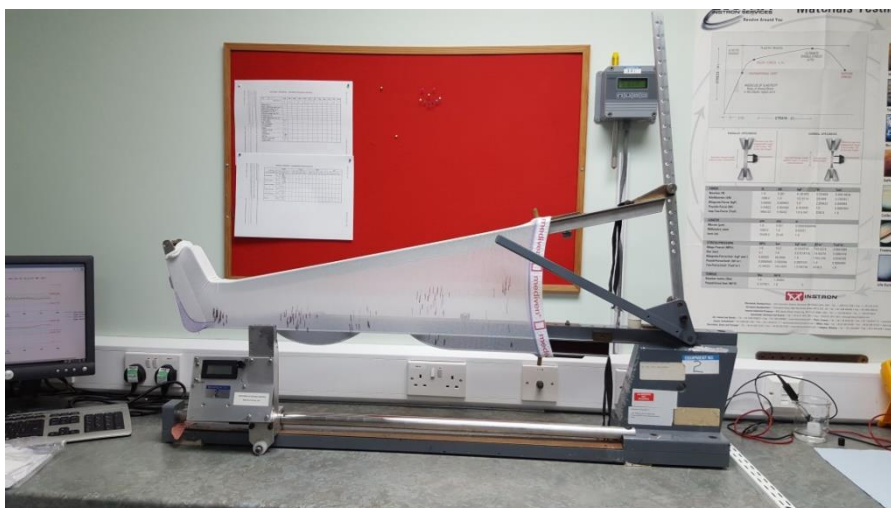
Ffigur 1 Hatra Mark II - Cyfarpar profi dilledyn cywasgu graddedig a ddefnyddiwyd fel rhan o'r Safon Brydeinig.
