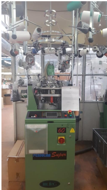
Ffigwr 4 Peiriant gwau cylchog a ddefnyddir yn Sallis Healthcare
